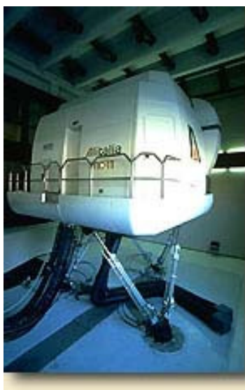
(Sinistra) La vista esterna del simulatore Alitalia che evidenzia i potenti stantuffi idraulici per il full motion.
